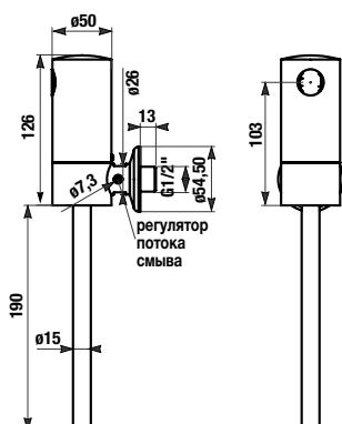
В комплект входит корпус из нержавеющей стали, шаровый вентиль, латунные шурупы для установки, пластиковый инсталляционный короб с соленоидным клапаном.
