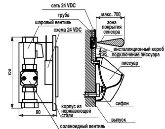
В комплект входит корпус из нержавеющей стали, шаровой вентиль, латунные шурупы для установки, пластиковый инсталляционный короб с соленоидным клапаном.
