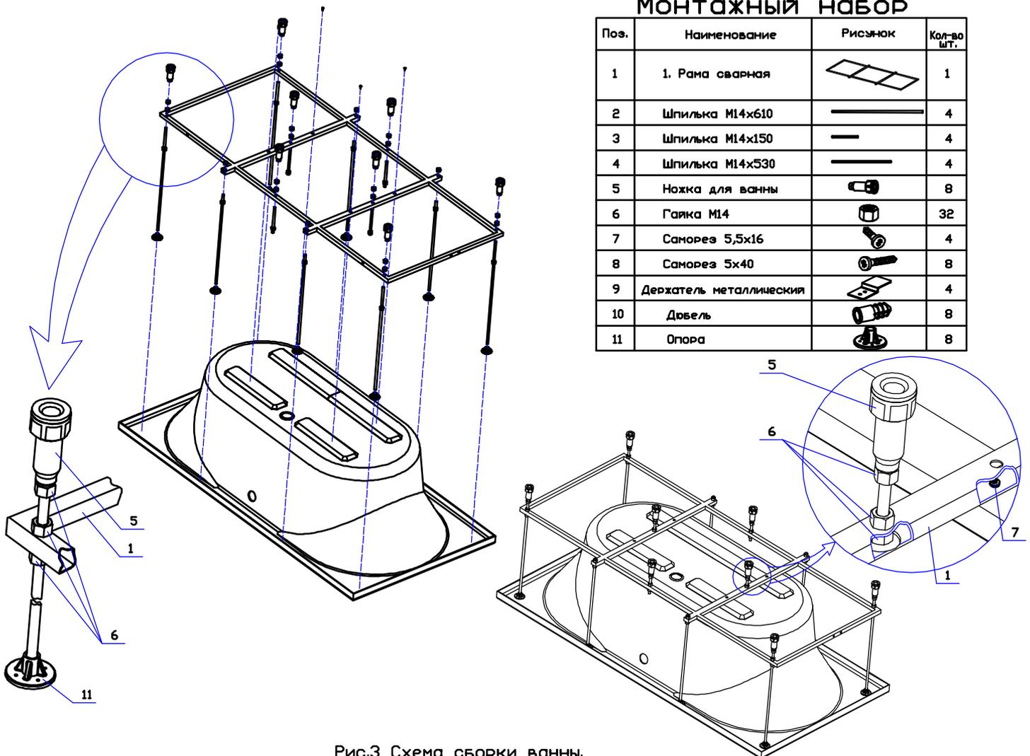
Рис.3 Схема сборки ванны.
