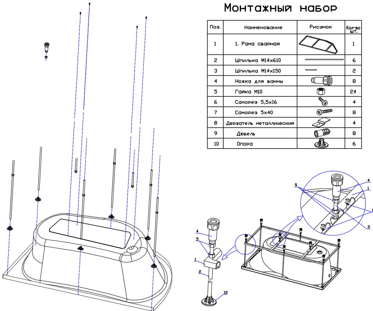
Рис.3 Схема сборки ванны.
