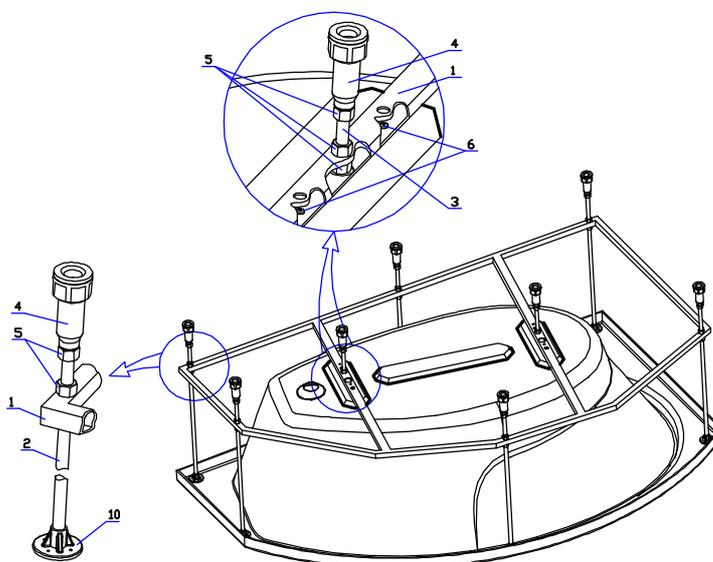
Рис.3 Схема сборки ванны.
