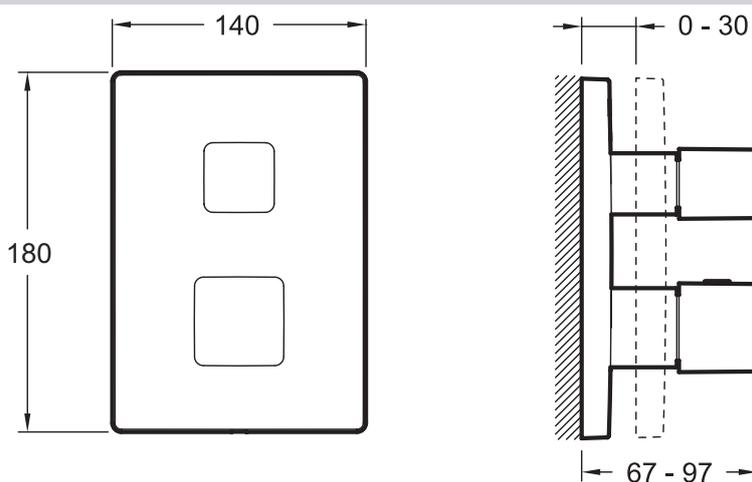
Спецификация продукта: Термостатический смеситель. E75391. Коллекция: MODULO. Вес: 2,9 кг. Тип установки: Встраиваемые. Термостатический смеситель на 2 выхода с запорным краном. Металлические заглушки и ручки. Встроенный запорный клапан G 1/2. Расход воды : 26 л/мин при давлении 3 бар. Устанавливается вместе с универсальной системой 98699D.
